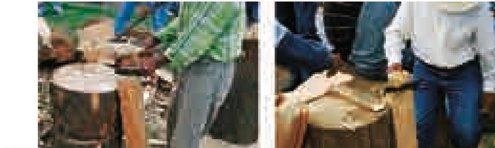
Figura 11. Marcado radial del inicio del desgajado del tejamanil.
