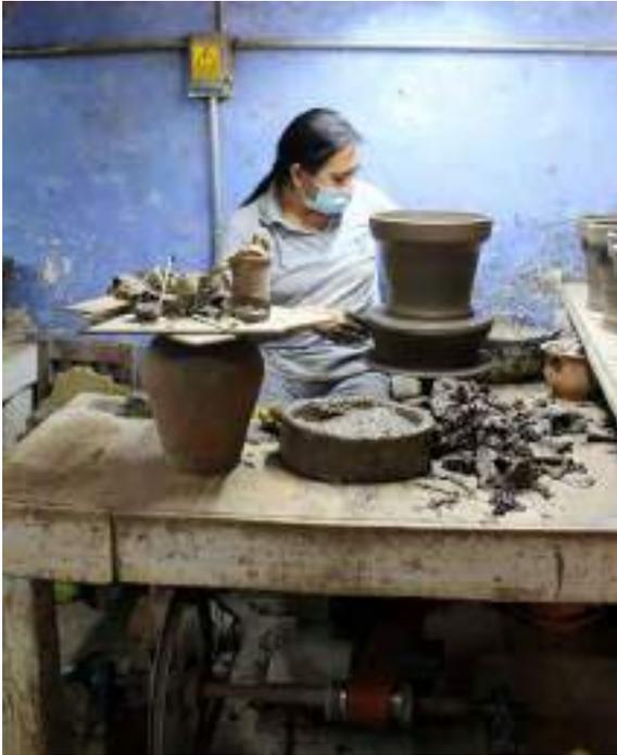
*Ilustración 20. Modelado con torno de una pieza. Uriarte Talavera. Foto: Rosana Calderón, 2022.*
