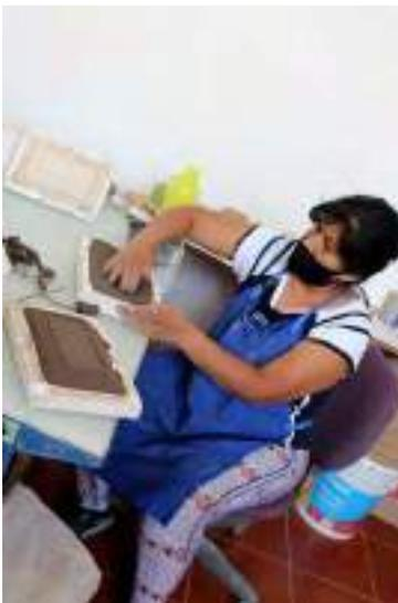
*Ilustración 21. Moldeado, utilizando moldes de yeso. Talavera de la Luz. Foto: Rosana Calderón, 2022.*
