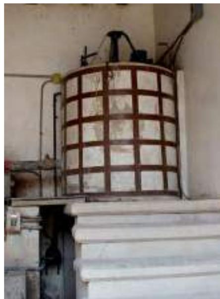
*Ilustración 15. Contenedor con un motor eléctrico que mezcla el barro hidratado, que posteriormente se tamiza. Talavera de la Luz. Foto: Rosana Calderón, 2022.*
