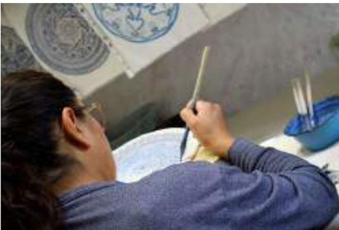
*Ilustración 28. Una vez marcado el diseño con el estarcidor se aplica la decoración, en este caso con técnica de plumeado. Talavera de la Luz. Foto: Rosana Calderón, 2022.*
