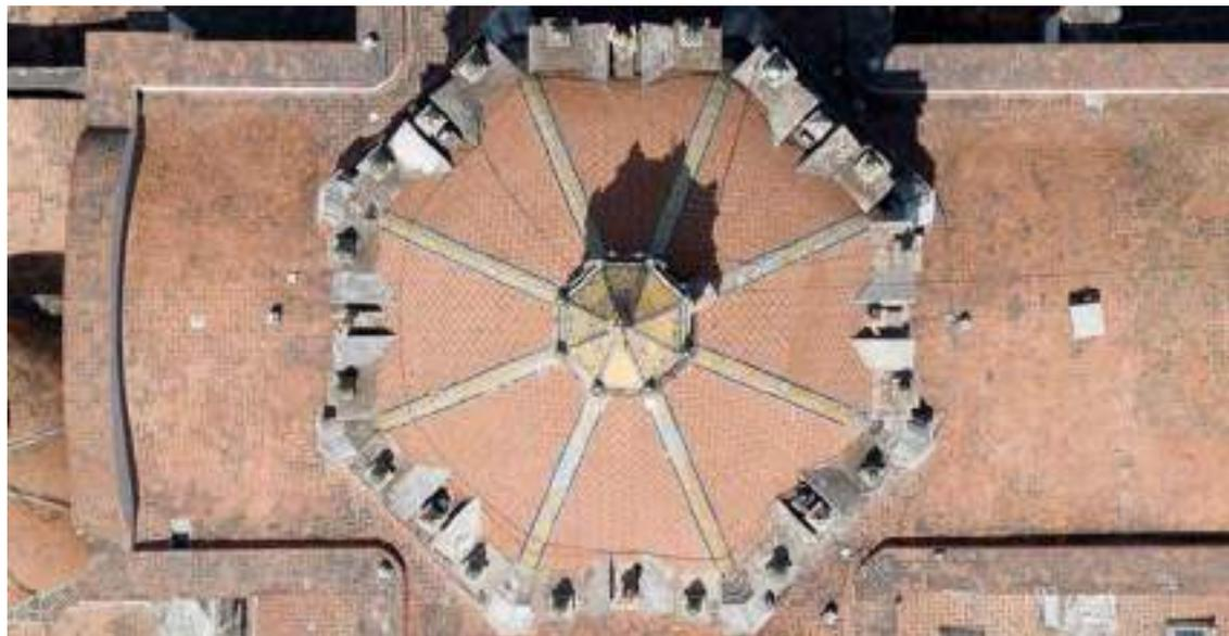
*Ilustración 135. Vista aérea de la cúpula de la capilla. Se pueden ver cambios en la decoración que marca las separaciones entre las secciones de la cúpula y tres secciones de la linternilla en la que se han repuesto mosaicos lisos en vez de la reproducción del diseño. Foto: Amy Bello, 2022.*
