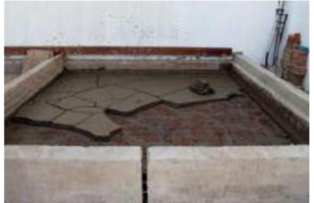
*Ilustración 17. Barro ya mezclado, se transfiere a una superficie que permite que se seque paulatinamente. Talavera de la Luz. Foto: Rosana Calderón, 2022.*
