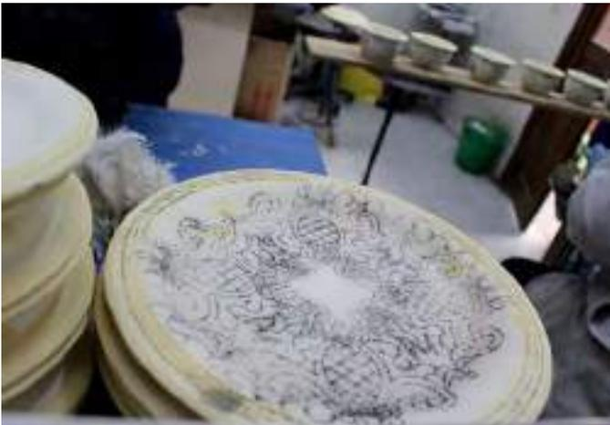
*Ilustración 27. Pieza con diseño marcado con ayuda de una plantilla o estarcidor. Uriarte Talavera. Foto: Rosana Calderón, 2022.*
