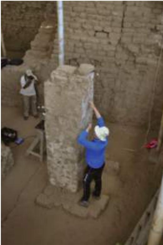
COLOCACIÓN DE ACELERÓMETROS
